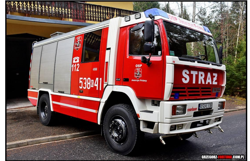
OSP Juszczyń Polany GBA 3,9/16/40 STEYR 94/2025 Średni sam. ratowniczo-gaśniczy na podwoziu STEYR PN EN 1846 M-2-9-3800-8/1600-1
